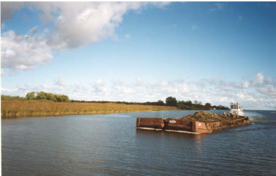
Foto 44. Puksiir-tõukur Tartu koos 600 tonnise kande võimega praamiga. Foto: Ain Adamsoni erakogu.
